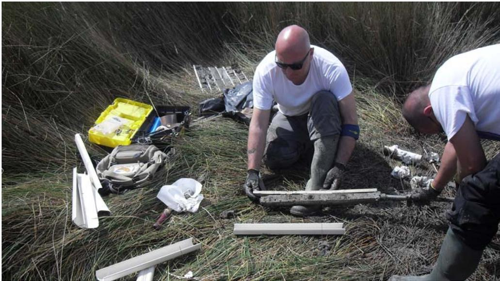
**Figura 3** – Carotiere utilizzato nei sondaggi.
